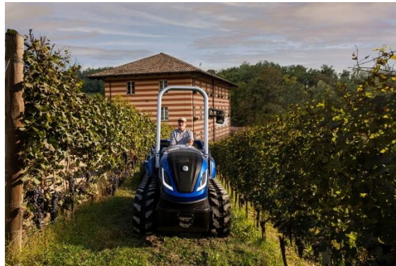
纽荷兰 (New Holland) TK 甲烷动力履带式葡萄园用拖拉机原型
