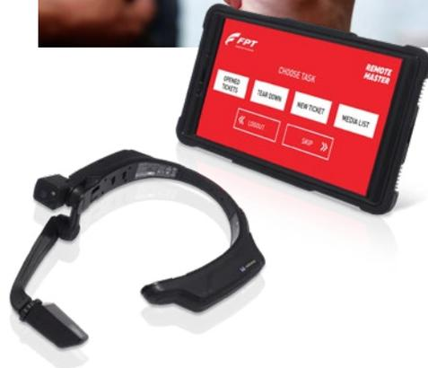
Mit Hilfe der mobilen Geräte und der Smart Glasses ist es möglich, eine direkte Fernverbindung mit dem Experten (Backoffice) herzustellen.
