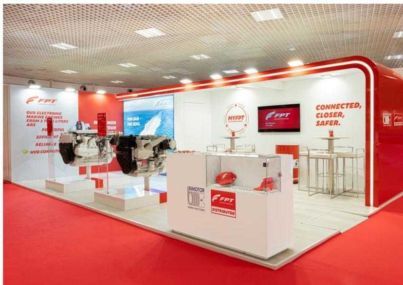
NEF 系列是该品牌最大的游艇和商用船舶用发动机系列产品，涵盖从 4 升到 6.7 升的四种不同排量，提供机械和电子版本。展出的这两款发动机凭借其先进的机械燃油喷射和电子共轨系统脱颖而出，并通过轻巧紧凑的设计、低油耗、低噪音和振动，确保了优秀的性能。
