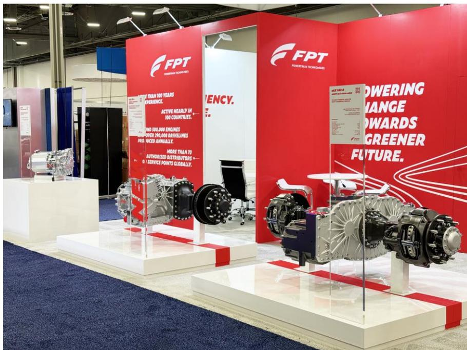
参观者可以近距离看到菲亚特动力科技的 6x4 电驱桥 eAX375，这是针对北美市场推出的首款电驱桥，也是其第二代电驱桥的 eAxles 的首款型号；市场上首款用于重型应用的电驱桥 eAX840-R；以及适用于轻型商用车的中央驱动器 eCD140，以及菲亚特动力科技（FPT
