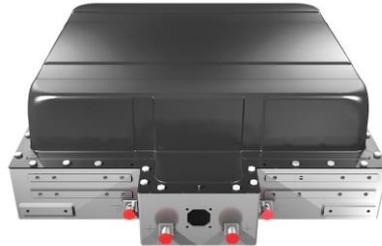
La transmisión central eCD 140 es una solución compacta y completa para integrar sistemas de propulsión eléctrica en la arquitectura de vehículos convencionales existentes, con un espacio residual optimizado para la instalación de paquetes de baterías. Para aplicaciones de tracción trasera, como todos los productos de FPT Industrial, el eCD 140 es **muy duradero, eficiente y confiable, con una vida útil de hasta 350.000 km.**
