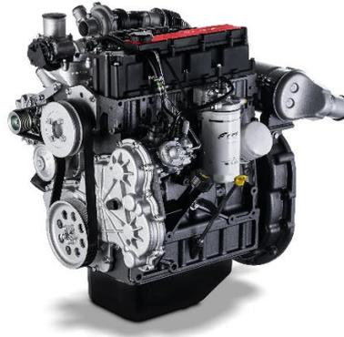
In termini di sostenibilità, l'F28 garantisce la conformità agli **standard emissivi Stage V e Tier 4 Final**, grazie al **sistema di post-trattamento estremamente compatto di FPT Industrial**. Questa soluzione fa uso di un catalizzatore di ossidazione diesel (DOC) associato al filtro antiparticolato diesel (DPF), che consente allo stesso motore di **soddisfare le normative sulle emissioni sia europee che nordamericane, garantendo al contempo un'erogazione di potenza elevata e costante**.
