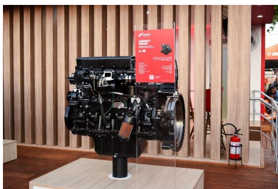
菲亚特动力科技 (FPT Industrial) 的 Cursor 9 Reman 再制造发动机
