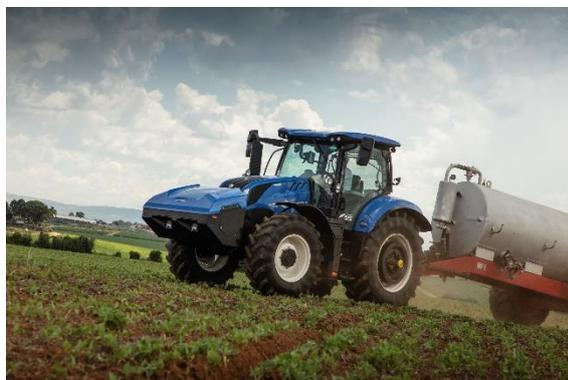
*T6 Methane Power da New Holland equipado com motor N67 NG da FPT Industrial*
