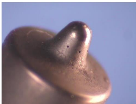
Ugello di un iniettore pulito
