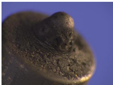
Ugello di un iniettore prima della pulizia
