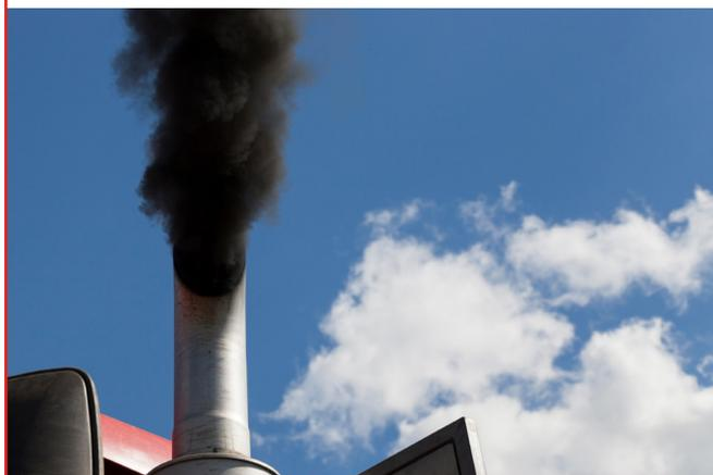
Le système de post-traitement (ATS) transforme également le monoxyde de carbone (CO) et les hydrocarbures (HC) qui sont issus de la combustion incomplète du carburant.
